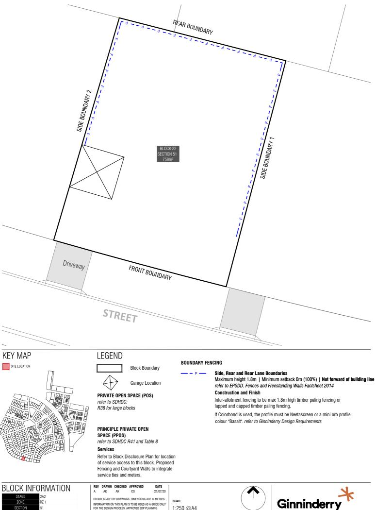
**BLOCK PLANNING CONTROLS** FENCING CONTROLS PLAN
