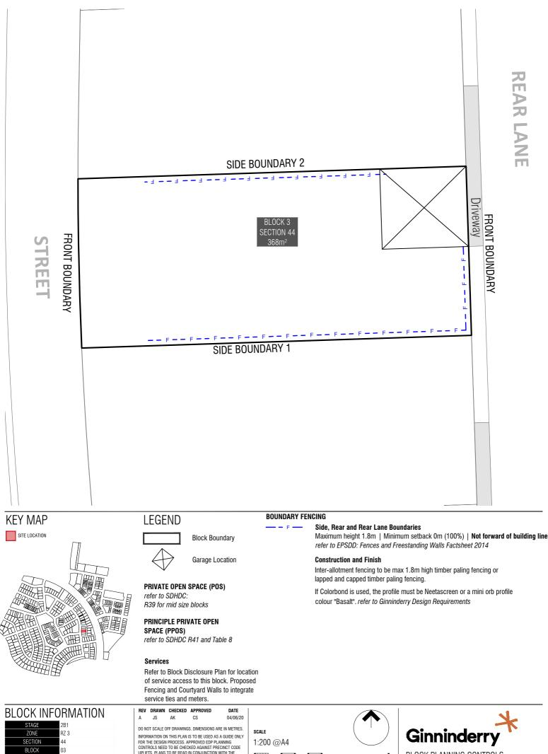
**BLOCK PLANNING CONTROLS** FENCING CONTROLS PLAN
